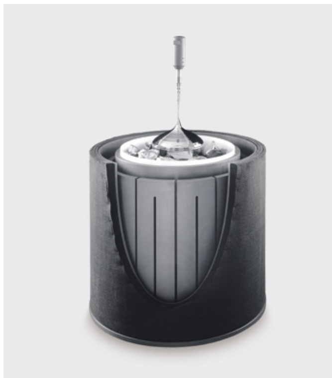
↑ 配备SIGRABOND Filwound 坩埚、SIGRAFINE 加热器和SIGRATHERM GFA 软毡保温的CZ直拉单晶炉热场
